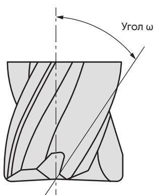
Концевые фрезы имеют углы наклона винтовой канавки от  $0^\circ$  до  $60^\circ$ . Стандартные концевые фрезы компании Микробор от  $30^\circ$  до  $48^\circ$ .
