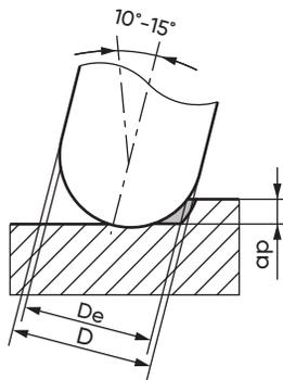
При работе сферическими фрезами скорость резания около центра фрезы близка к нулю. Также затруднено удаление стружки.
