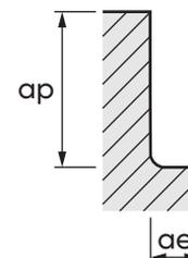
Для высоколегированных, легированных закаленных - отпущенных и аустенитных нержавеющей сталей глубина фрезерования 1.5D и ширина ae - не более 20% от диаметра.
