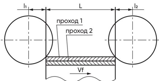
$$T_0 = \frac{L \times l_1 + l_2}{Vf} \times i \text{ (мин)}$$
